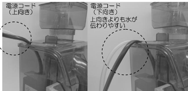
電源コードは、下向きよりも上向きに取り回した方が、水が伝わりにくくなります。コンセント付近の対策だけでなく、ろ過槽本体から出ている電源コードの取り回しを上向きにしておくことも漏電、ショート防止対策としておすすめします。
